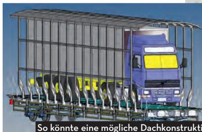
So könnte eine mögliche Dachkonstruktion auf einem Flachwagen von RDC aussehen.
